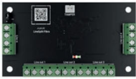
Modul zur Aufteilung von einer Fibra Leitung in vier
